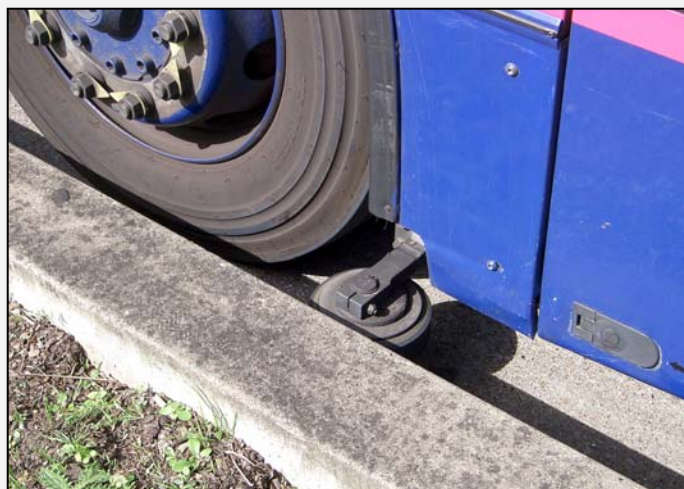
Roue de guidage du busway d'Ipswich (Royaume-Uni) Photo : www.wikipedia.org
