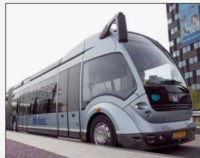
Développé par une filiale de la société néerlandaise VDL, le Phileas est un bus hybride guidé au sol par des aimants. Déjà en service depuis 2004 à Eindhoven, le Phileas roulera à Douai d'ici fin 2007. Photo : http://nldp.edc.nl
