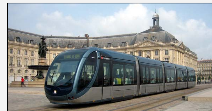
Tram de Bordeaux avec alimentation par le sol (APS) en centre-ville Photo : www.transbus.org
